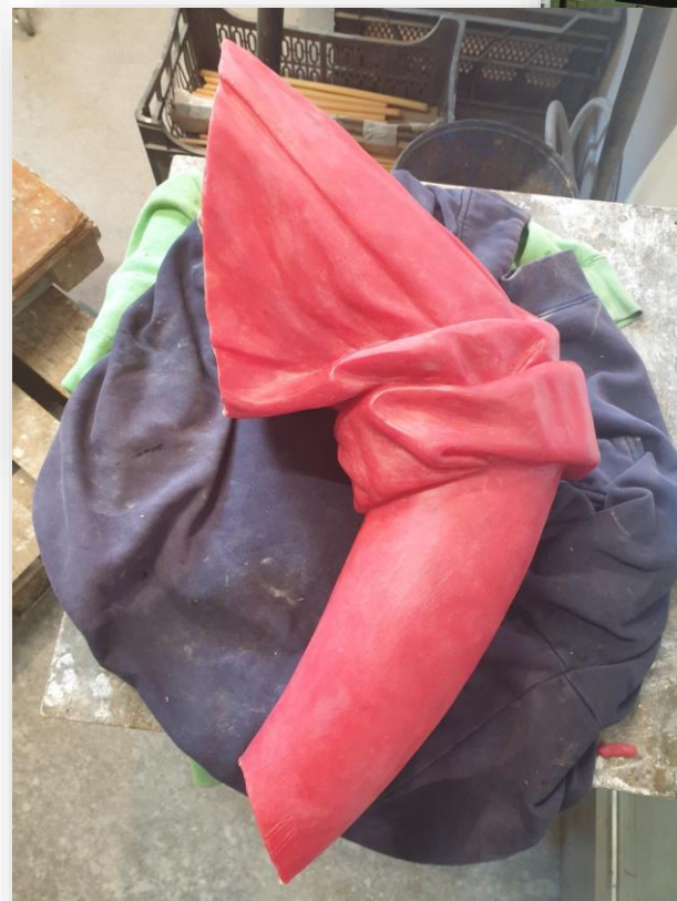
Holle-was-modellen, tussenstadium van het gietproces
