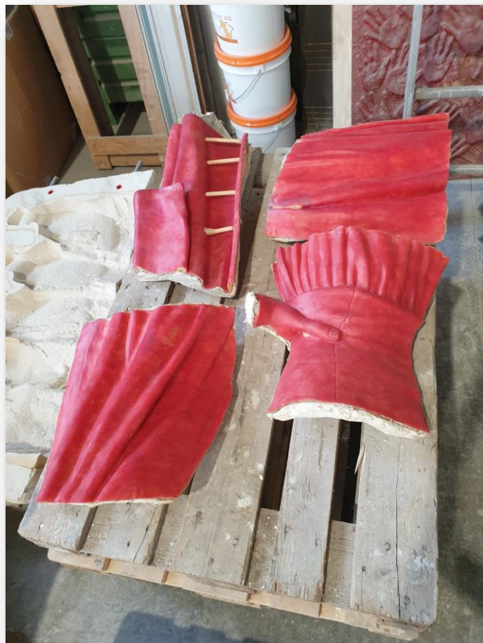
Holle-was-modellen, tussenstadium van het gietproces
